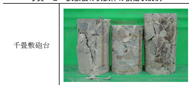
写真-2 試験後の供試体の損傷状況例
