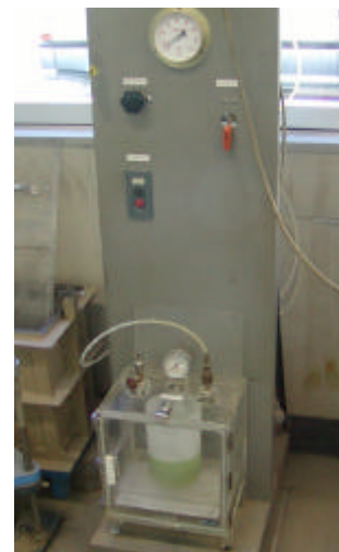
写真3 真空脱泡装置 全景
